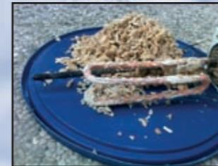
Bild: Schaden nach 6 Jahren bei 18 dH Wasserhärte
